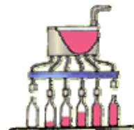
Vor dem Abfüllen muss der Wein völlig stabil sein. Er bleibt oxidations- und krankheitsanfällig, bis der Korken in der Flasche sitzt. Das Abfüllen geschieht heute zu 95 Prozent in maschinellen Abfüllanlagen. Wichtig ist, dass die Flasche auf die genau richtige Höhe gefüllt wird, damit noch Raum für den Korken bleibt.
